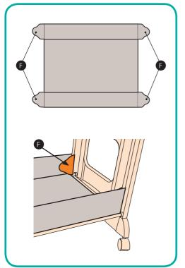
5. Installer l'étagère du bas à travers la structure, sur les tubes du bas. Entourer les accroches (F) autour des tubes du haut de la structure et clipper- les.
