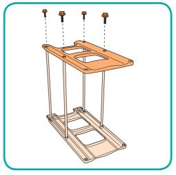
2. Placer le meuble à langer sur le côté et attacher le deuxième panneau d'extrémité en utilisant les quatre boulons pour le fixer.
