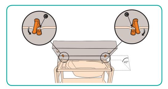
8. Remonter la tige métallique d'environ 45° et insérer-la dans les clips se trouvant sous le matelas à langer. Insérer les encoches (C) dans les clips, fermez -les et reposer le matelas à langer.
