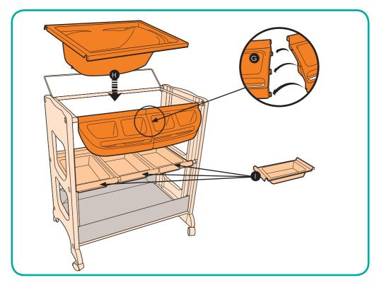
6. Assembler les deux rangements du côté(G) et accrocher-les sur les rebords de la structure du haut. Placer la baignoire (H) dans la structure du haut, accrocher-la audessus des rangements des côtés (G).
