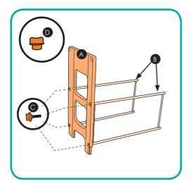
1 .Attacher un panneau d'extrémité (A) aux 2 cadres latéraux (B) en utilisant les boulons (C) resserrer-les en utilisant l'outil de serrage prévu à cet effet (D).
