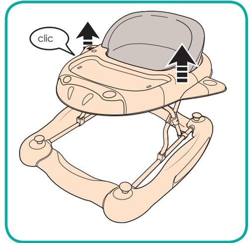
2. **Pour fermer:** Tenez l'avant du trotteur et en même temps, tournez et tirez le mécanisme de verrouillage vers l'avant et abaissez la partie supérieure du trotteur vers le bas.
