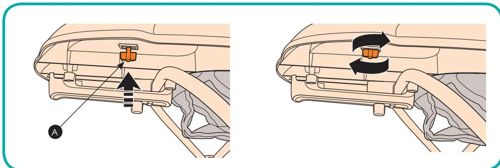
3. Fixez le plateau à jouet au trotteur en accrochant les languettes (A) situées sous le trotteur dans les trous correspondants du plateau à jouet, puis en tournant les languettes pour fixer le plateau en place.
