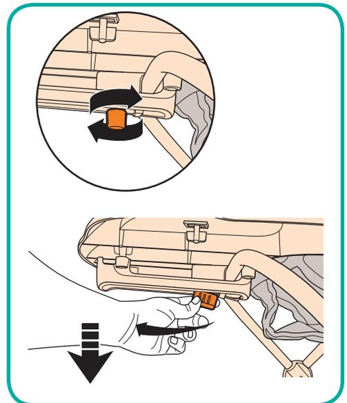
3. **Pour régler la hauteur:** La méthode la plus simple pour régler la hauteur consiste à abaisser la partie supérieure du trotteur au maximum (comme ci-dessus, à l'étape 2), puis à tirer la partie supérieure du trotteur vers le haut de manière à atteindre une des trois hauteurs possibles.
